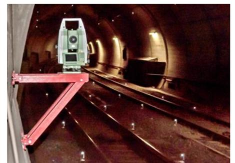
Gleis Monitoring mit Totalstation
