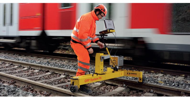
Mit den mobilen Messlösungen von Amberg Technologies ermitteln Sie schnell und effizient Gleislagefehler für Bau und Instandhaltung im Schotteroberbau. Ob auf Hochgeschwindigkeitsstrecken oder Bahnhofsgleisen, Amberg Tamping stellt uneingeschränkt Korrekturdaten höchster Qualität für den Gleisbau zur Verfügung.
