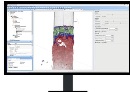
Mit Amberg TunnelScan können Sie Punktwolkendaten georeferenzieren, bereinigen und anhand des theoretischen Entwurfs analysieren. Darüber hinaus sind weitere tunnelspezifische Analysen und Berichte enthalten, wie z. B. Schichtdicken, Welligkeit (Oberflächenglätte) und mehr.
