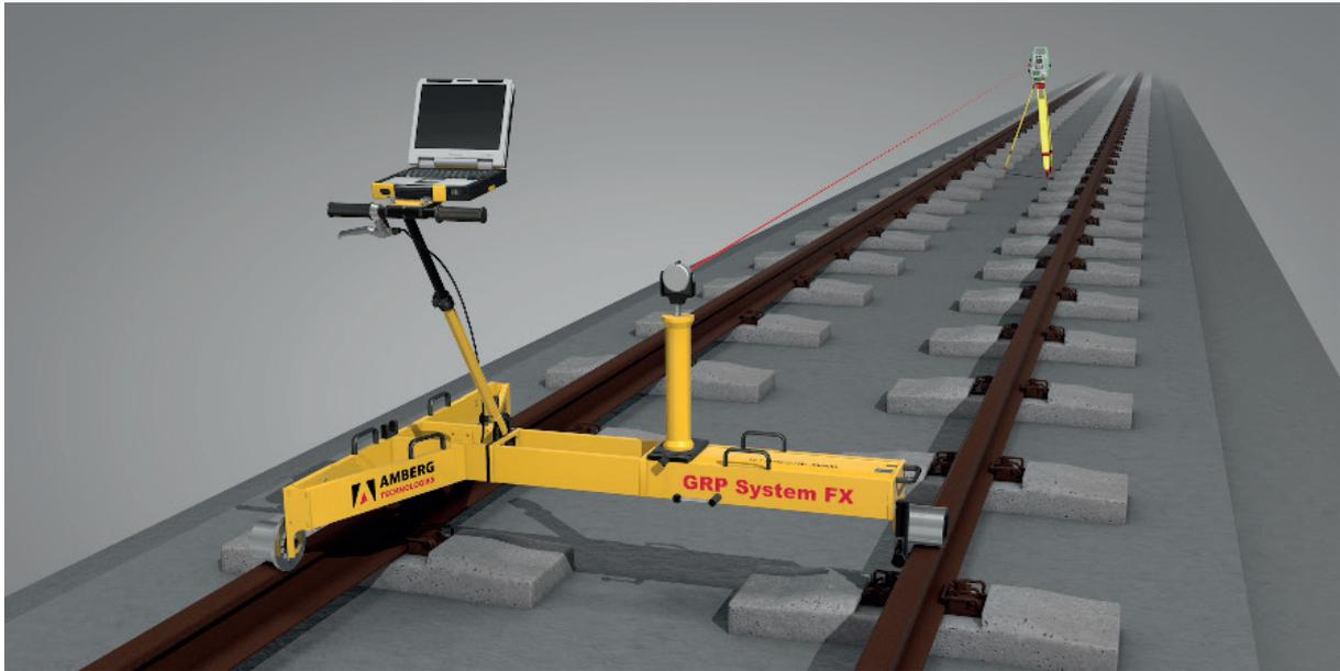
Integrierte Messlösung, optimiert für die typischen Anforderungen während des Baus, der Überwachung und Instandhaltung von Fester Fahrbahn
