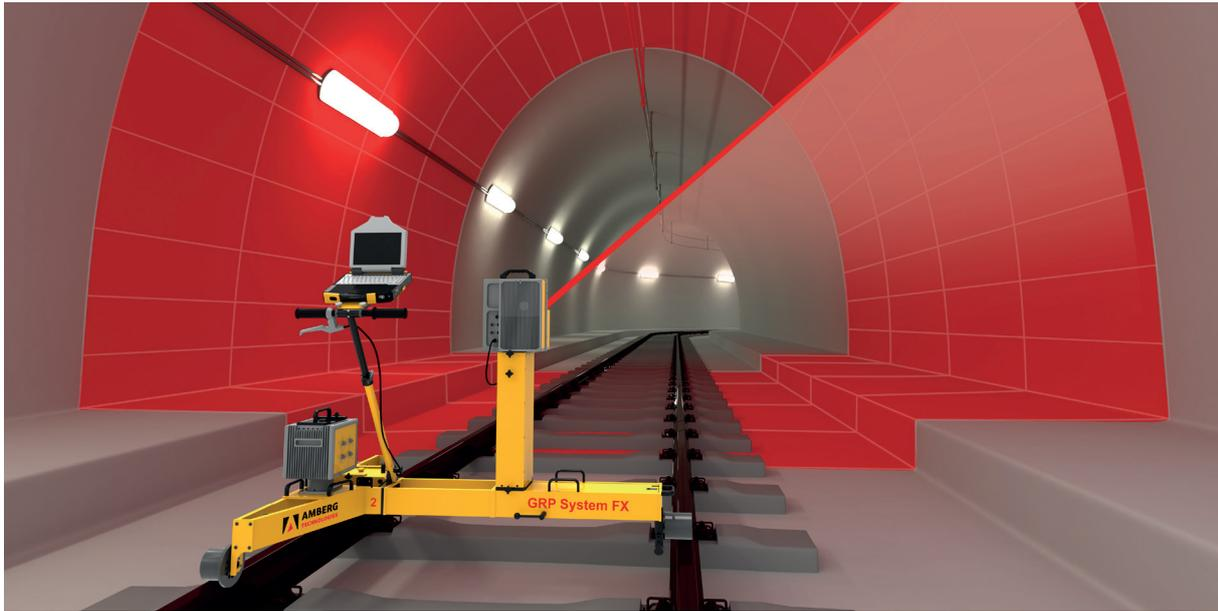
Modulare Systemlösung für manuelle und automatische Lichtraumvermessung, einschliesslich einem leistungsfähigen Werkzeug für statische und dynamische Lichtraumanalysen
